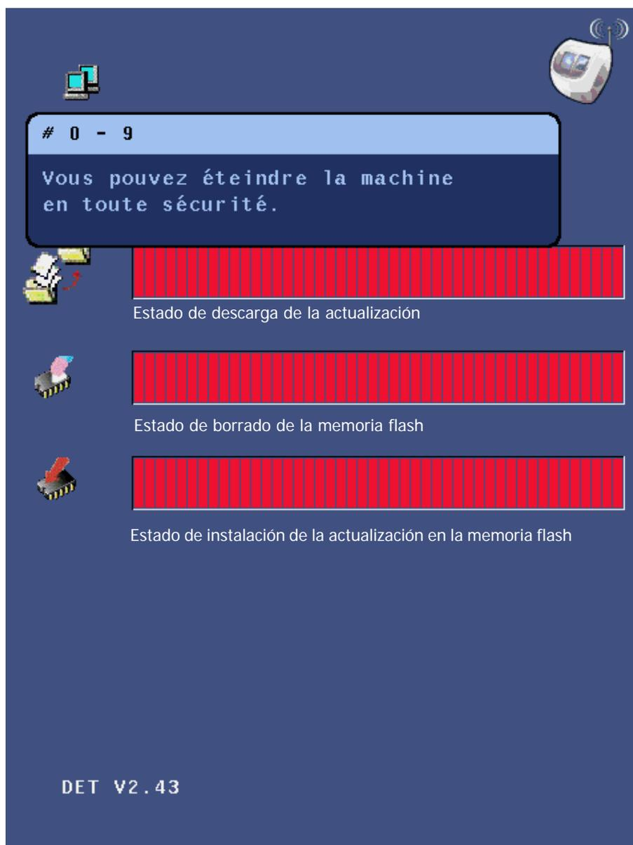
Una vez instalada la actualización en la memoria flash, es necesario reiniciar la biseladora para completar la instalación.
