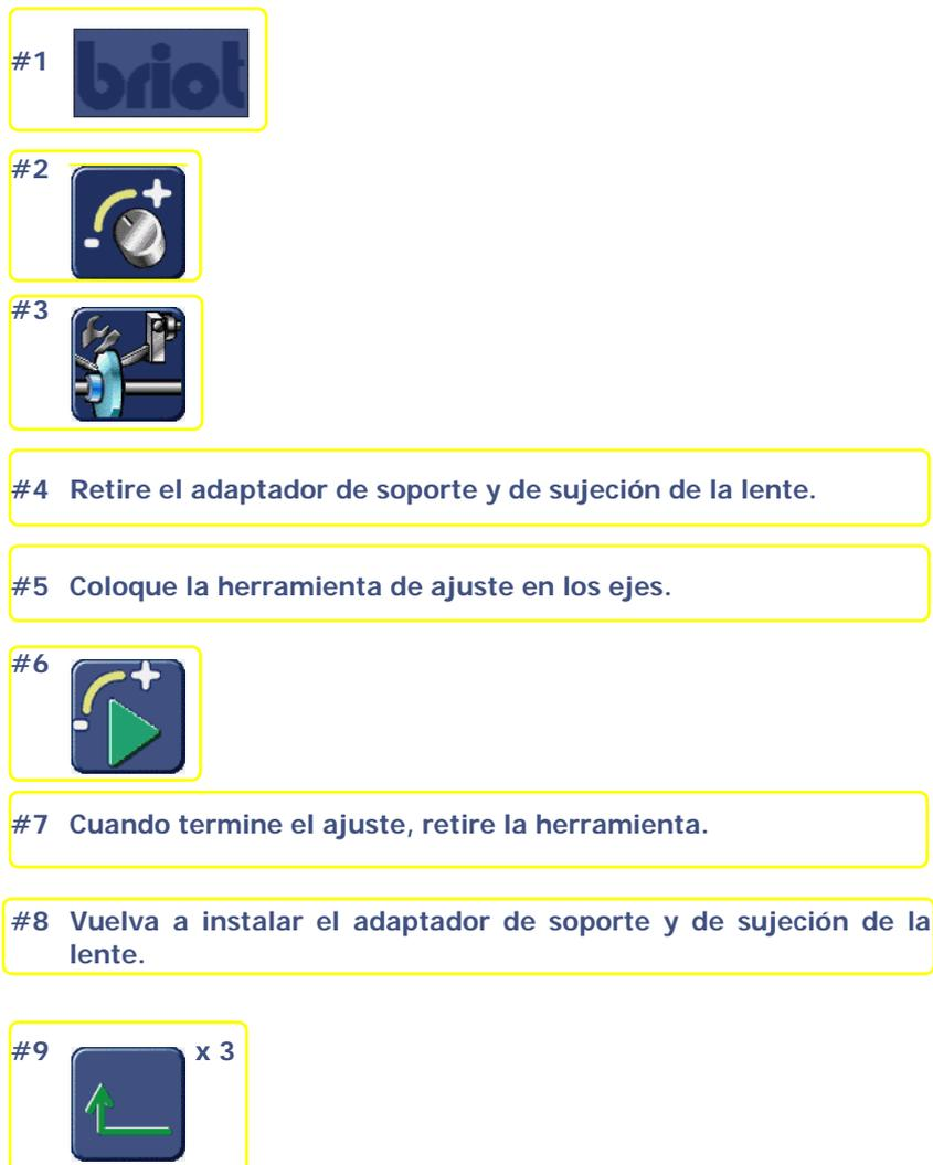
Diagrama de flujo 5-10: Ajuste de la palpación
