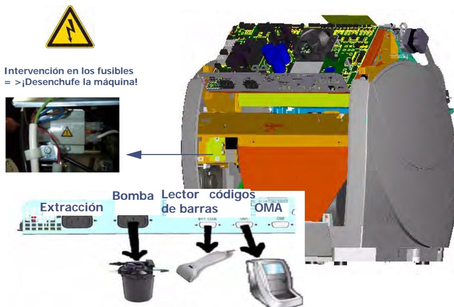
Ilustración 1-7: Conexiones eléctricas
