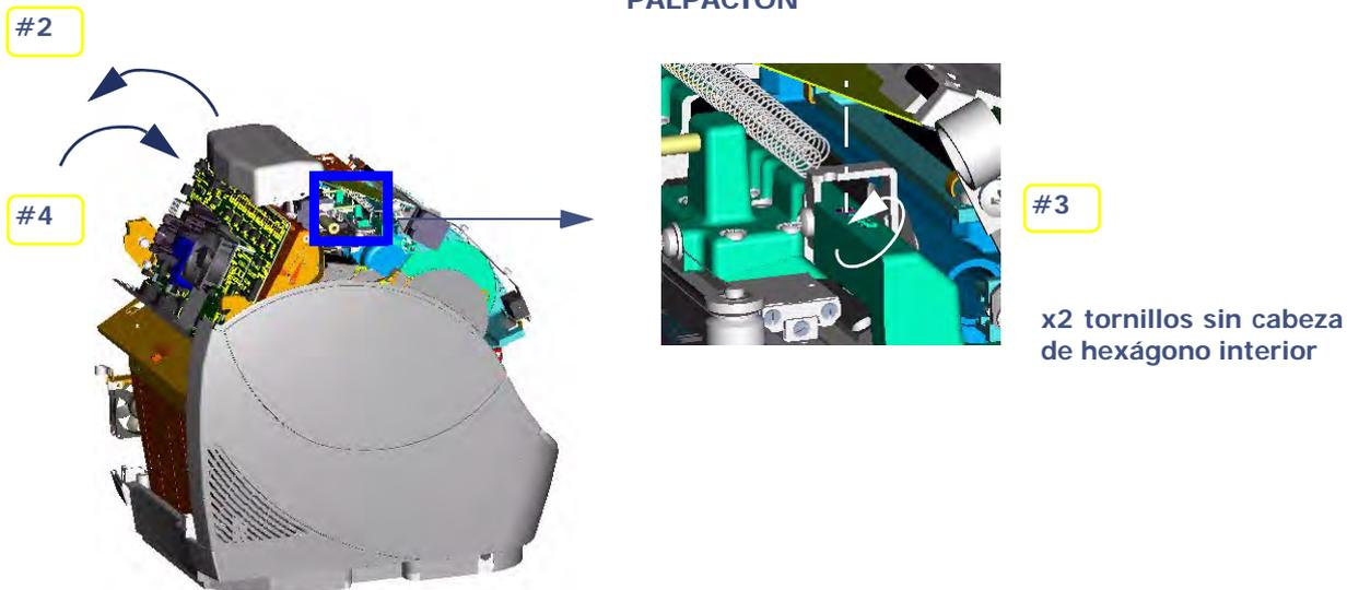
**=> EXTRACCIÓN DE LAS ABRAZADERAS DEL CARRO**
