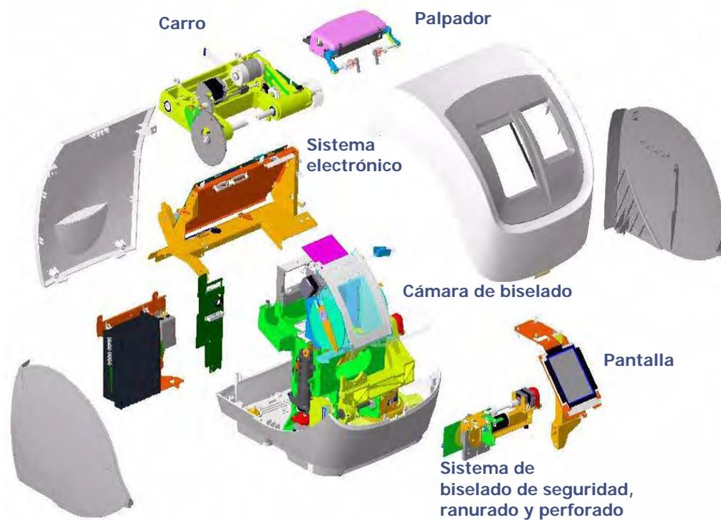
Ilustración 3-2: Vista despiezada de la biseladora
