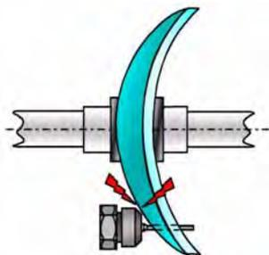
Ejemplo: Un orificio perforado a 19 mm desde el centro de bloqueo a 0° en una lente de +7D será ciego.
