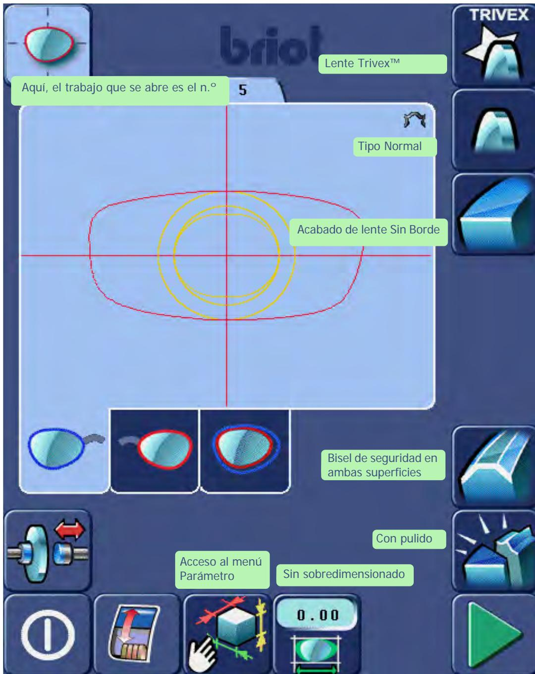
Pantalla 3-18: Ejemplo de la producción de un trabajo con acabado de lente Sin Borde
