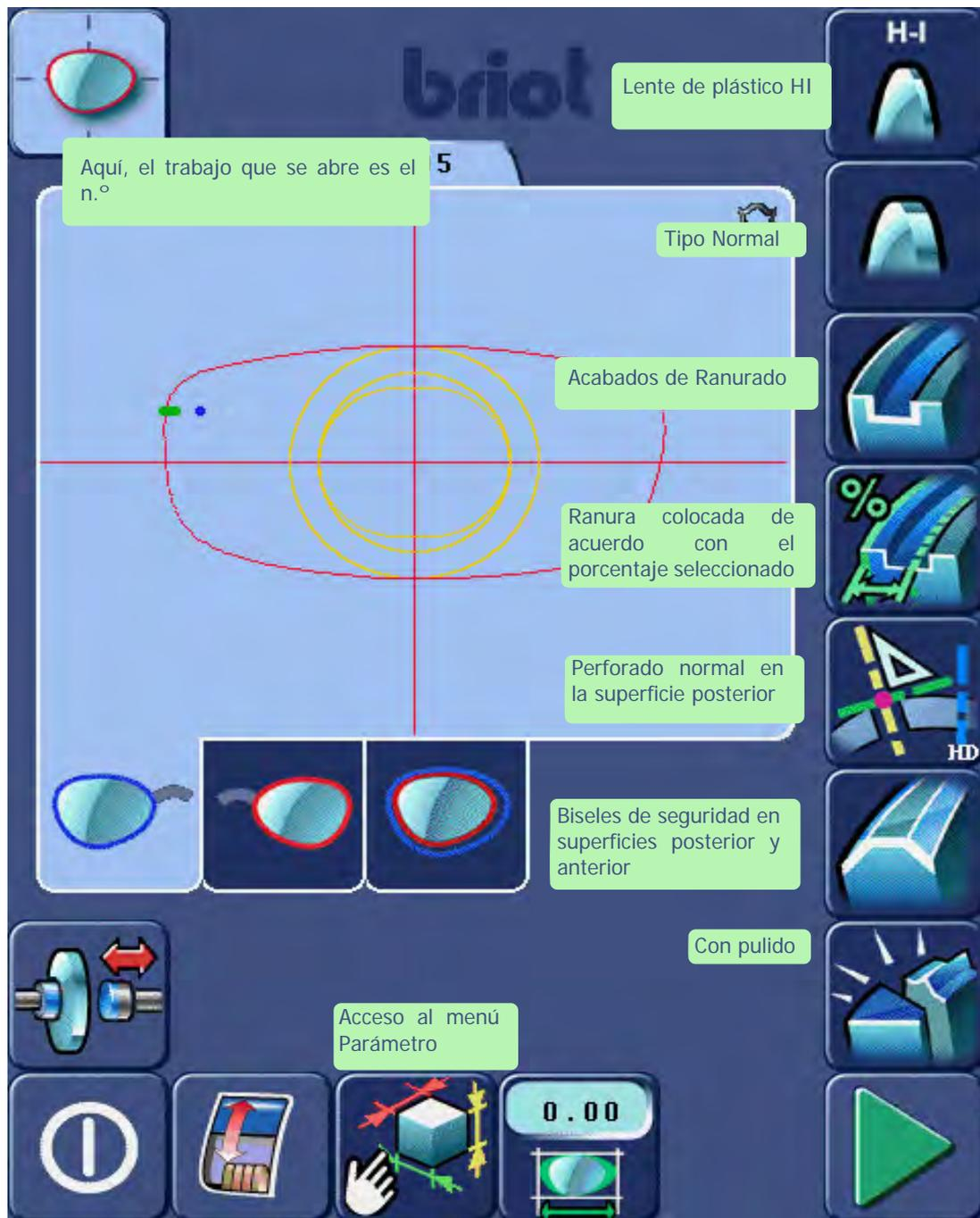
Pantalla 3-21: Ejemplo de producción de un trabajo con acabados de Ranurado y Perforado
