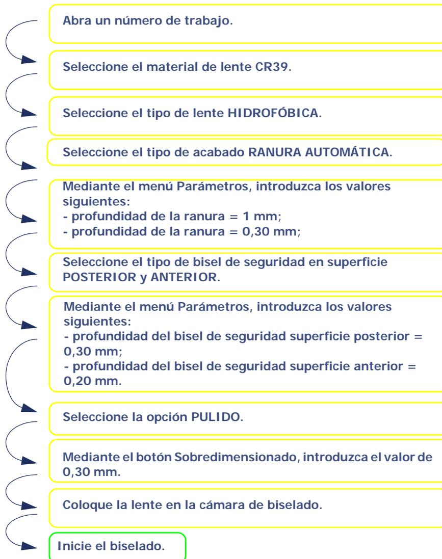
Diagrama de flujo 3-5: Producción de un trabajo con acabado de Ranura
