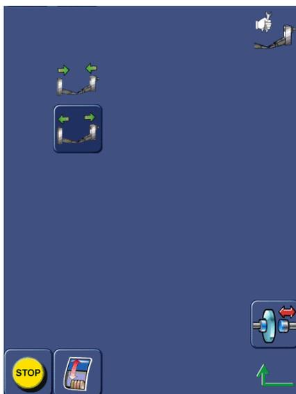
⇒ Confirme y vaya automáticamente a la pantalla de ajuste del palpador
