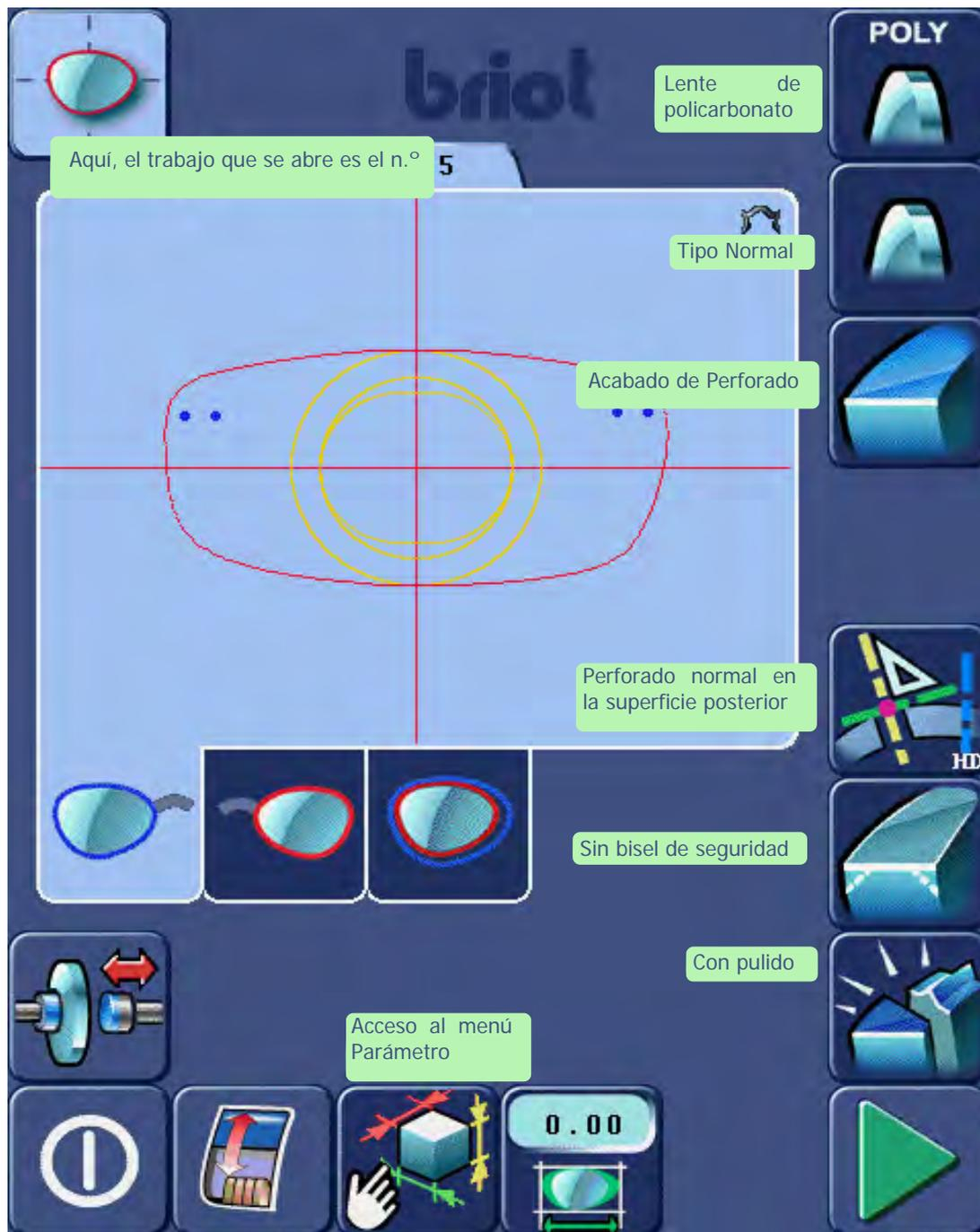
Pantalla 3-20: Ejemplo de producción de un trabajo con acabado de Perforado
