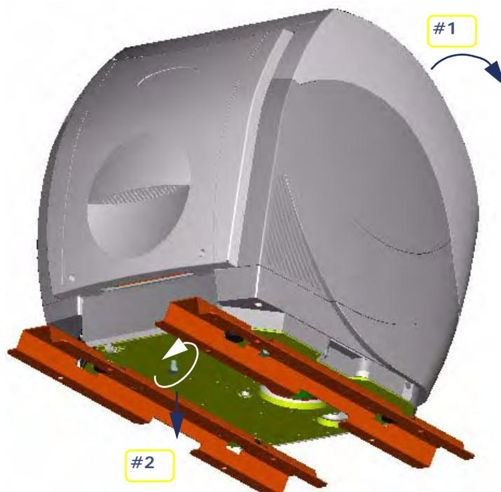
Ilustración 1-1: Extracción del tornillo de sujeción del motor
