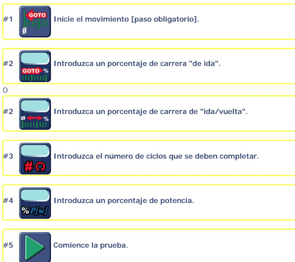
Diagrama de flujo 6-1: Principio de funcionamiento de una pantalla de prueba tipo
