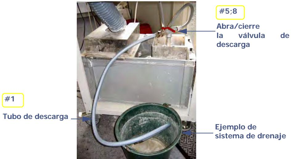
Ilustración 5-8: Conexiones para el agua
