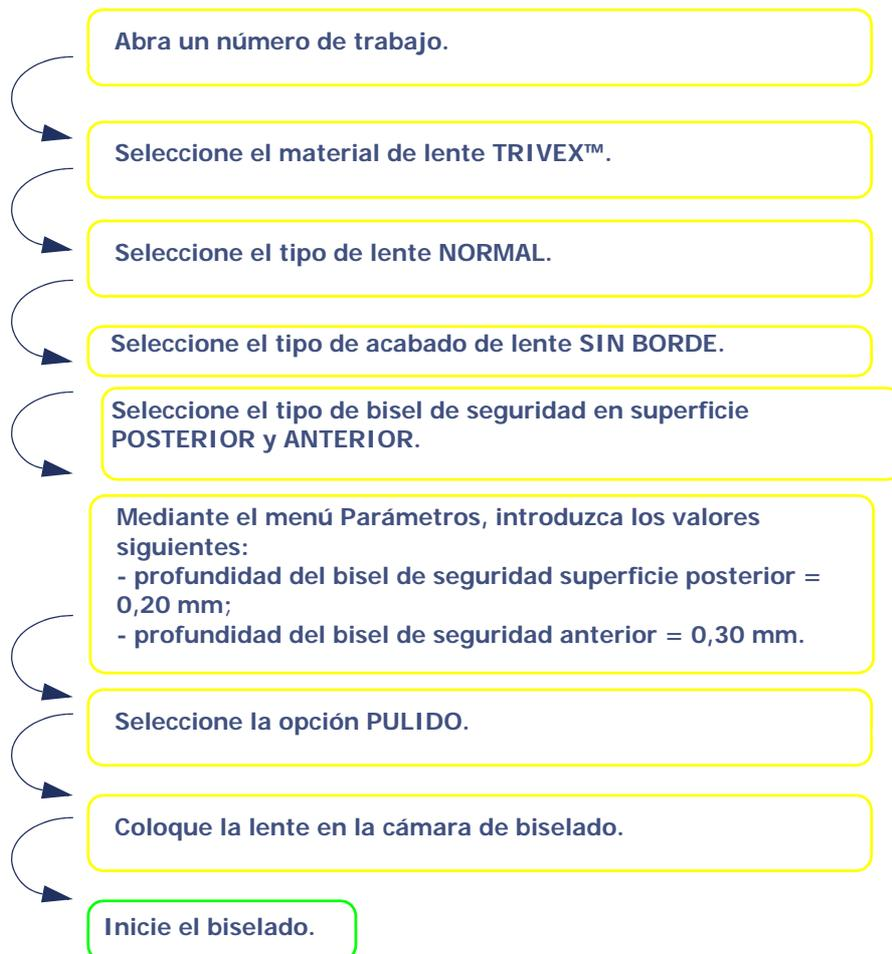
Diagrama de flujo 3-4: Producción de un trabajo con acabado de lente Sin Borde
