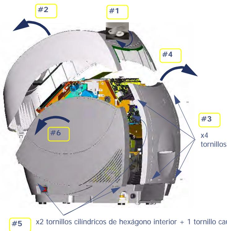
Ilustración 1-3: Extracción de las cubiertas
