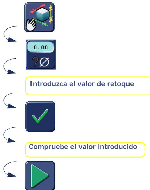
Diagrama de flujo 3-9: Retoque de perforación idéntico en todos los orificios
