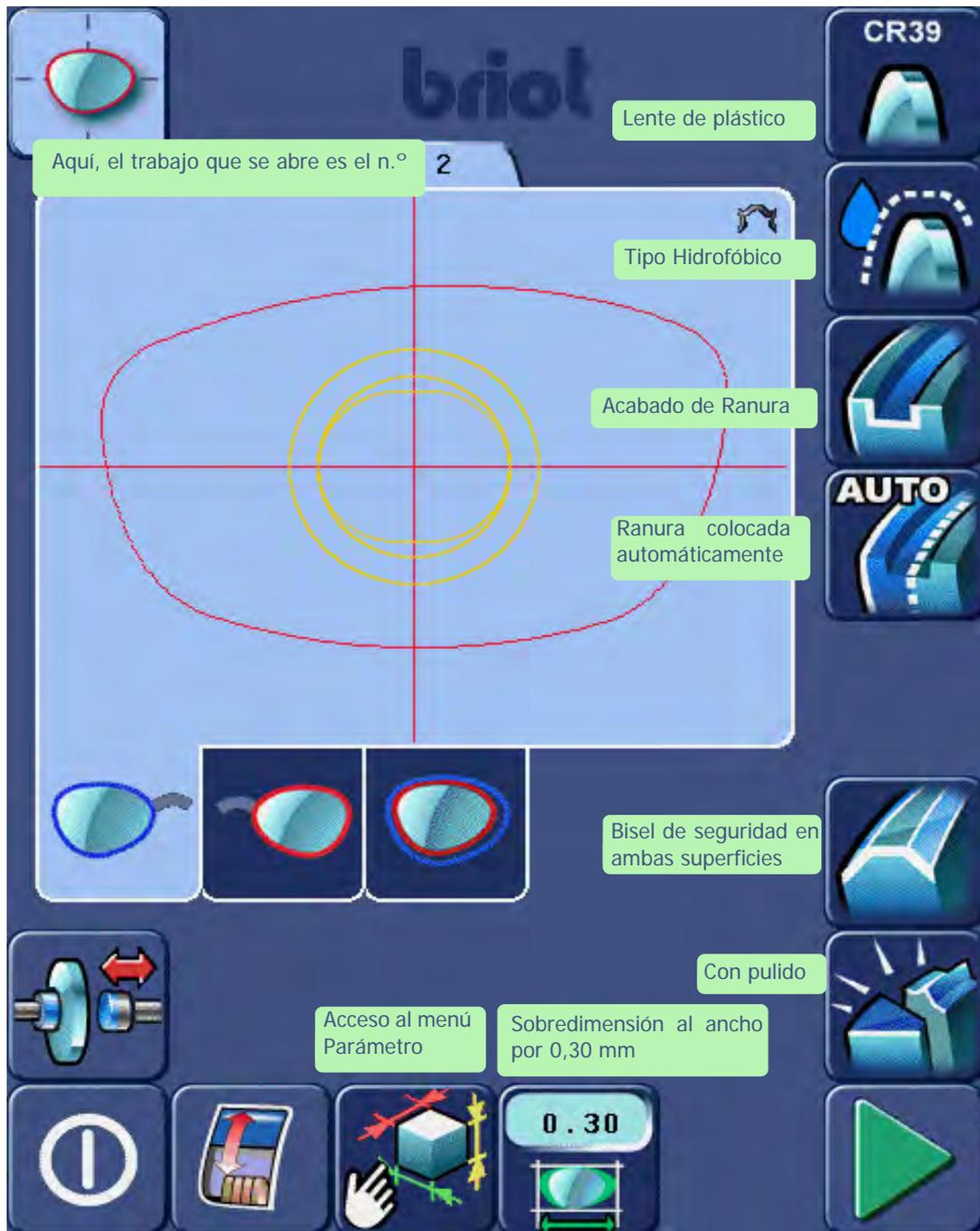
Pantalla 3-19: Ejemplo de producción de un trabajo con Ranura
