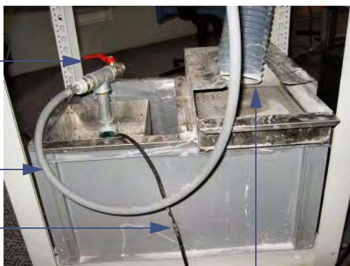
Tubo de drenaje colocado encima del filtro del receptáculo limpio
