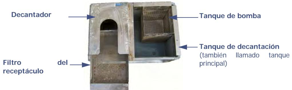
Ilustración 5-5: Limpieza del filtro del receptáculo
