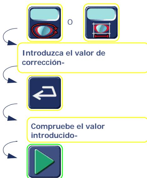
Diagrama de flujo 3-8: Introducción de un valor de sobredimensionado
