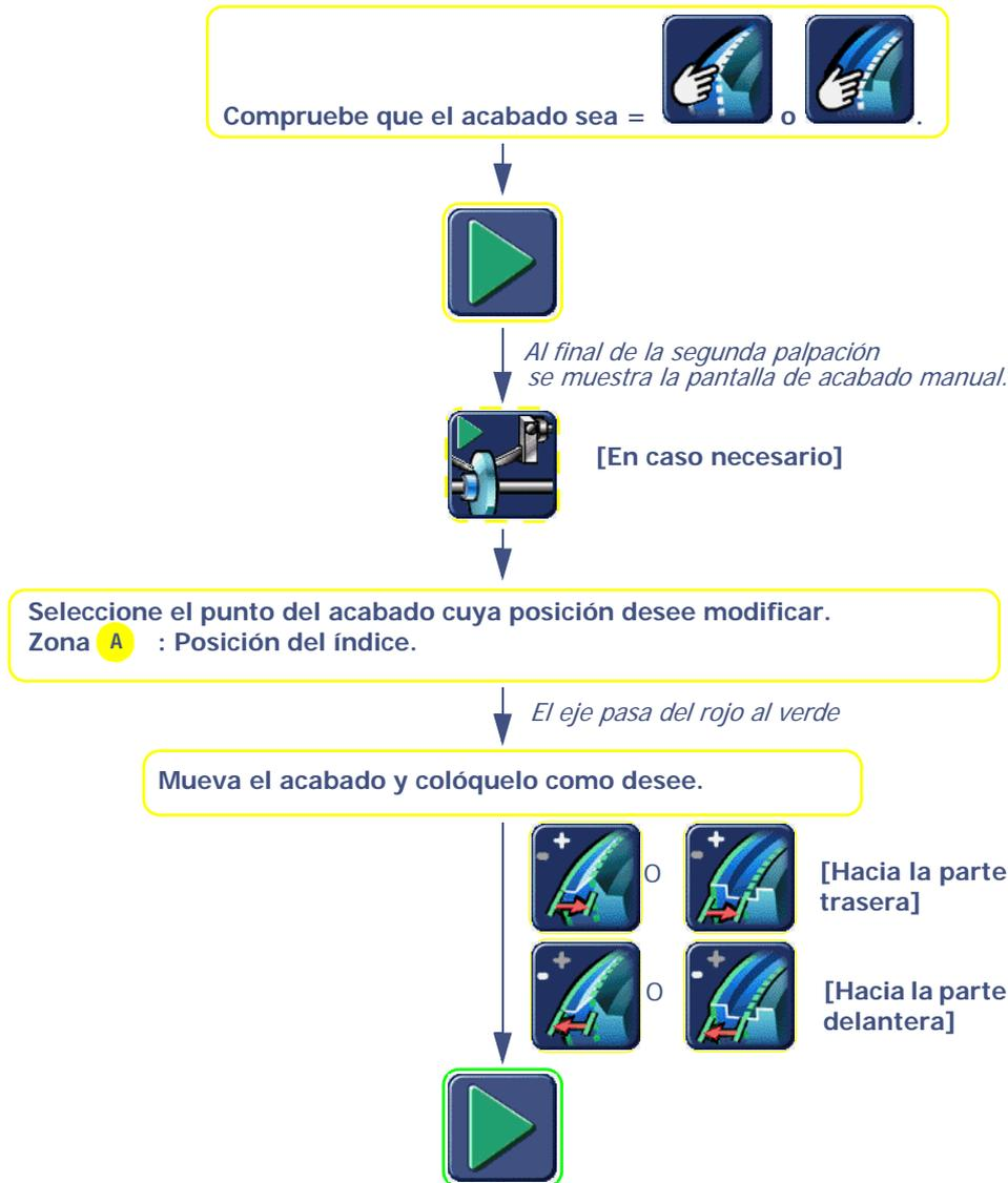
Diagrama de flujo 3-16: Posicionamiento manual de un acabado
