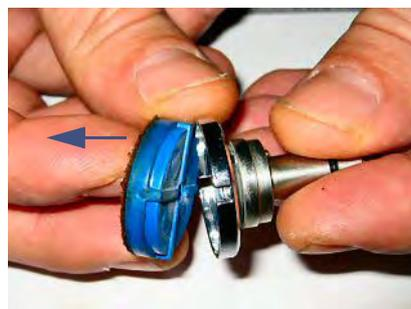
Ilustración 5-1: Sustitución del adaptador de sujeción de lente oscilante
