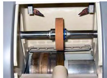
Pantalla 5-4: Reacondicionamiento de un disco
