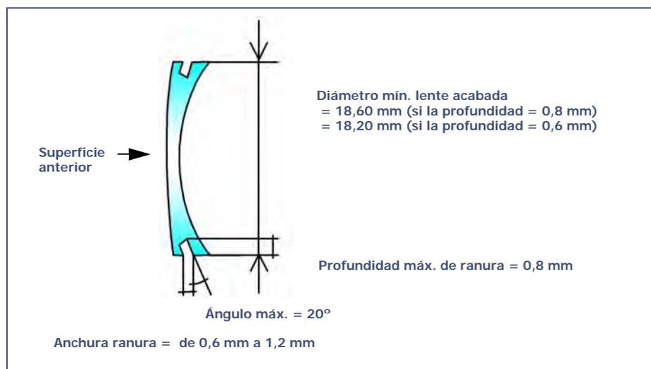
Ilustración 3-6: Límites de producción de una ranura inclinada
