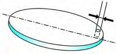
*Observación: Cuando se recibe el trabajo en la biseladora, si éste incluye al menos un orificio de un diámetro inferior al diámetro de la fresa, la máquina mostrará el siguiente mensaje de advertencia: "Diámetro de perforación > Diámetro del orificio. ¿Desea perforar?" Si contesta Sí: el diámetro mínimo de los orificios será igual al diámetro de la fresa. Si contesta No: todo el plan de perforación se ignorará y no se perforará ningún orificio. La lente se acabará sin borde.*
