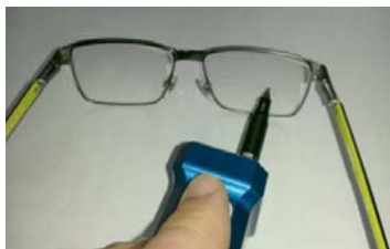
Illustration 3-3 : Trazado de una lente
