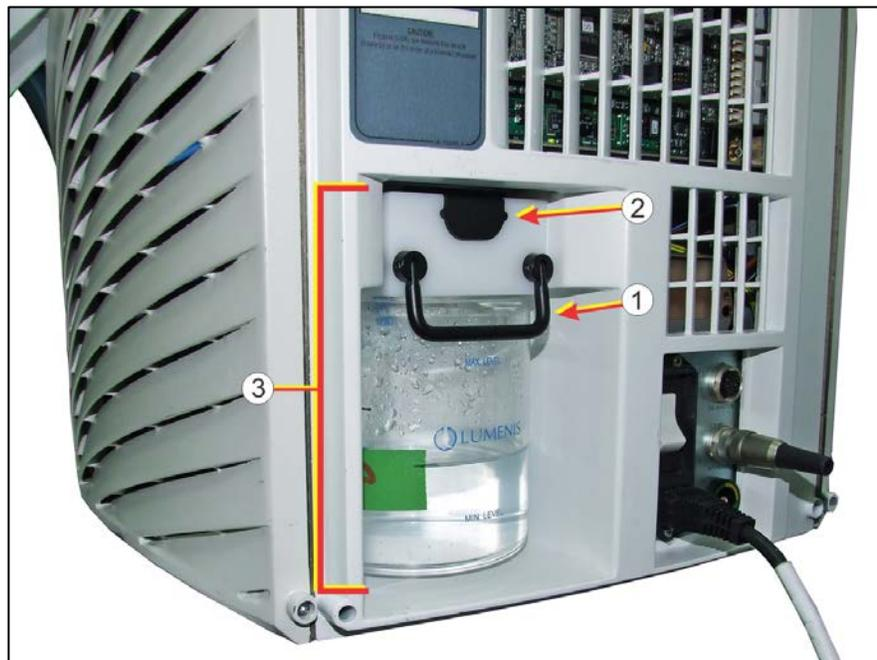
**Figura 6-20: Mantenimiento del depósito de refrigerante**
