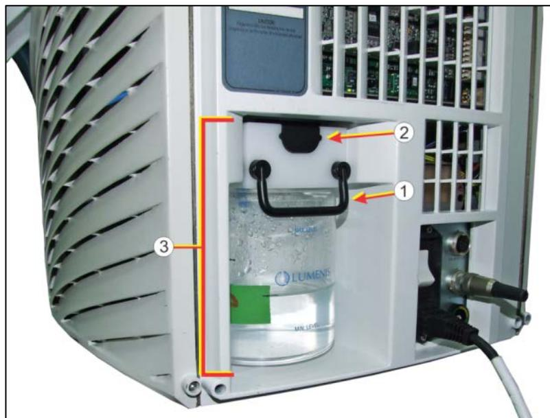
*Figura 3-8: Depósito de refrigerante*
