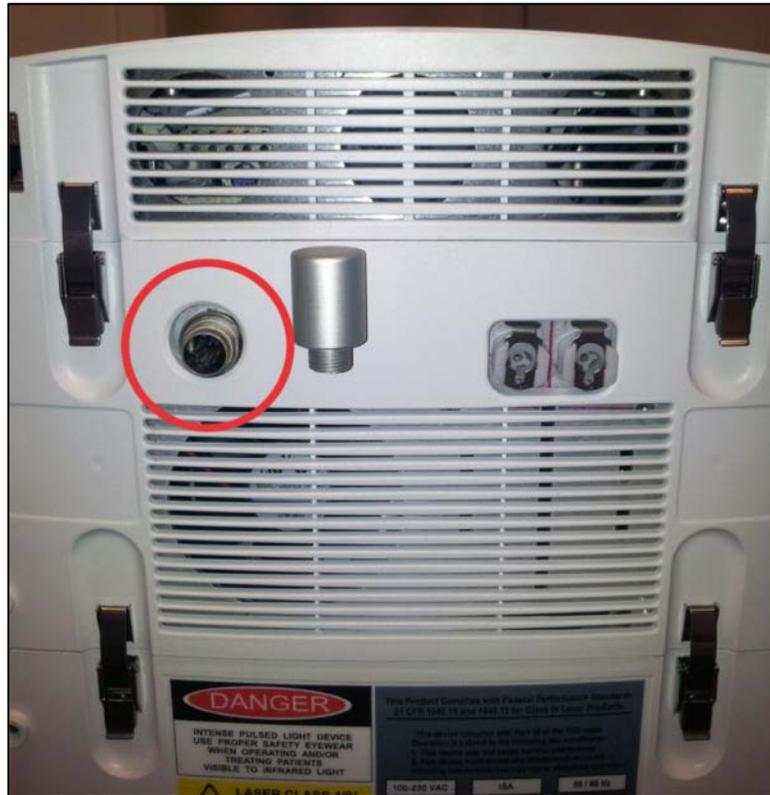
**Figura 3-7: Puerto de conexión del pedal**
