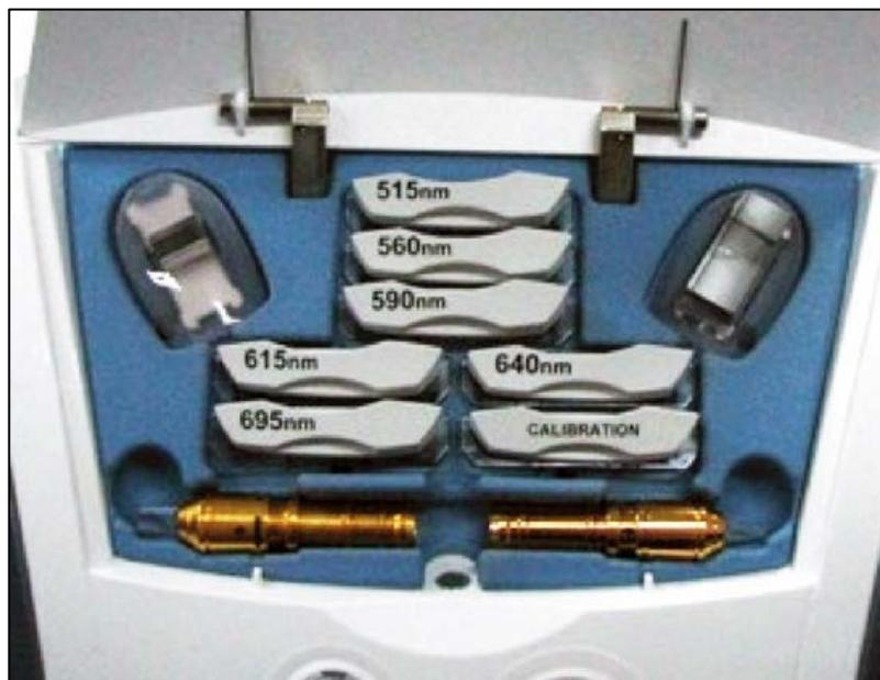
*Figura 7-1: Bandeja para guardar las guías de luz y filtros*
