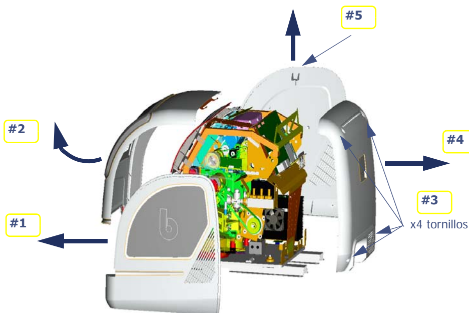
Ilustración 1-3: Extracción de las cubiertas
