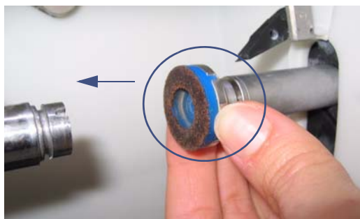
Ilustración 5-1: Sustitución del adaptador de sujeción de lente oscilante
