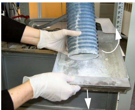
Ilustración 5-6: Limpieza completa de los tanques y los filtros
