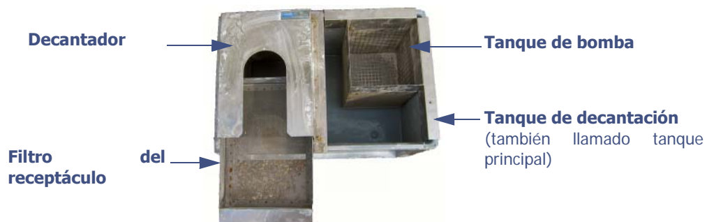
Ilustración 5-5: Limpieza del filtro del receptáculo
