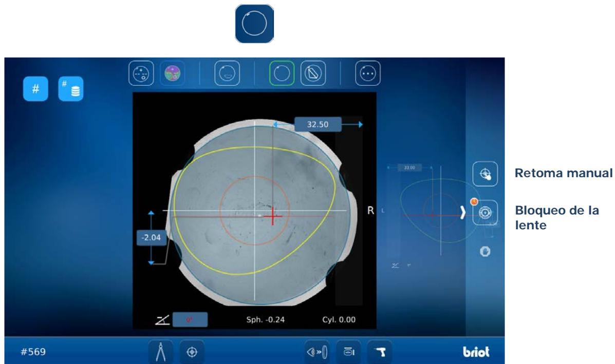
*Sugerencia: Si desea realizar una retoma manual en una lente monofocal, le aconsejamos que pase al modo «Tres Puntos» y que apunte la lente mediante el frontofocómetro.*
