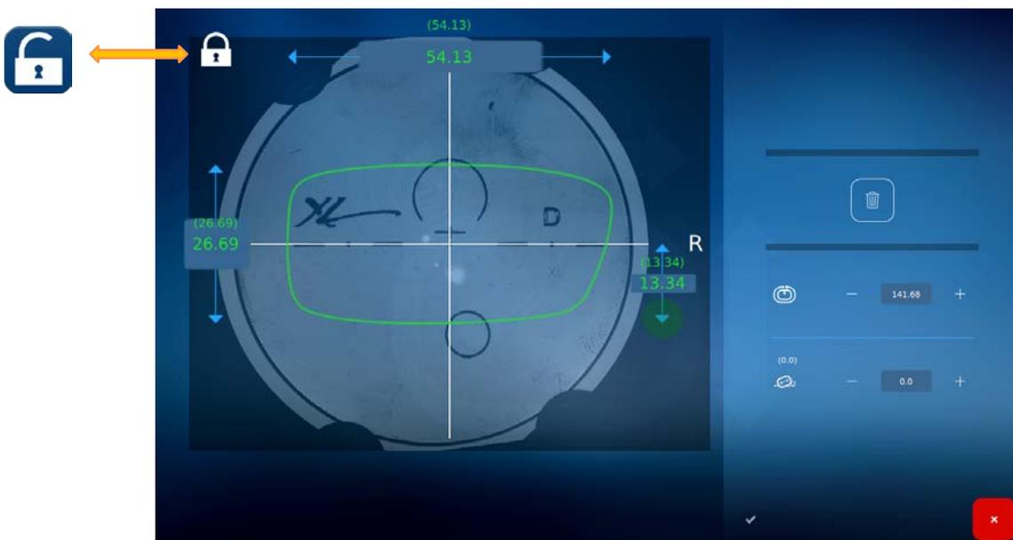
Para modificar los valores que aparecen en la pantalla (en color verde), pulse el valor que desea cambiar (1), de forma que aparezca el teclado numérico, o bien pulse la zona verde, para estirar la parte inferior de la forma (2). En ese momento se visualizará la nueva forma (en color naranja). Puede confirmar (3).
