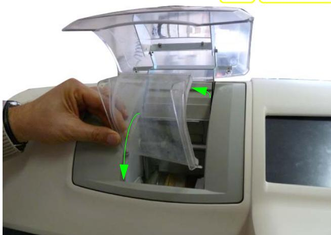
Ilustración 5-8: Limpieza y sustitución del visor extraíble
