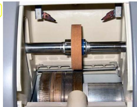
Ilustración 5-7: Reacondicionamiento de un disco
