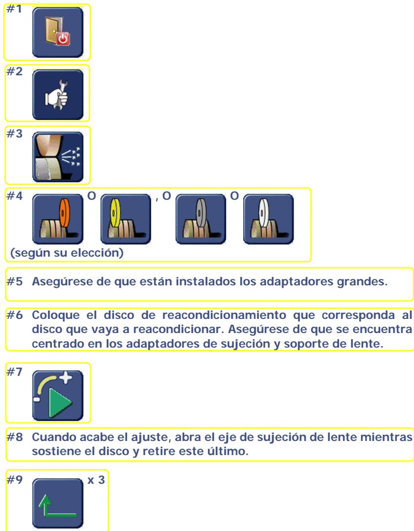
Gráfico de flujo 5-4: Reacondicionamiento de un disco
