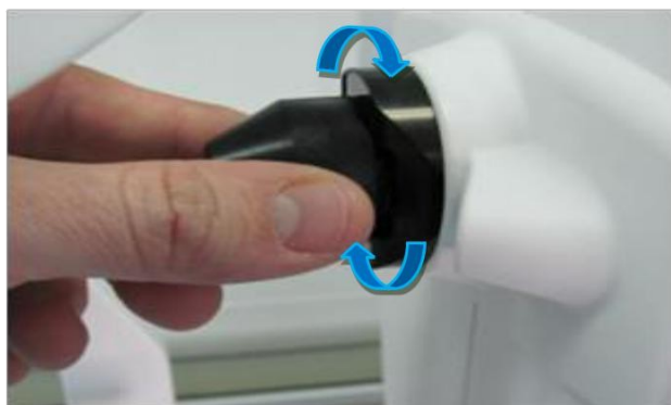
Figura 38. Montaje de adaptador de segmento anterior. Gire a tope.
