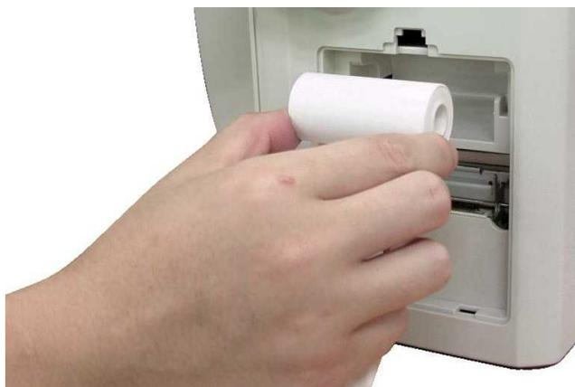
5. Volver a colocar la pieza de metal en su sitio y alimentar el papel en la ranura en la parte inferior del compartimento.
